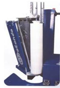
Die schnelle Filmeinführung erlaubt das wechseln der Rolle innerhalb weniger Sekunden.
